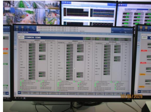
รูปที่ 3-2 ระบบเตือน (Alarm) เพื่อควบคุมค่าการระบาย \text{NO}_x
